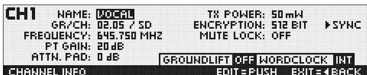
A través de la ventana de información de canal puede acceder a una vista general rápida sobre los parámetros de sintonización (grupo/canal, frecuencia, nombre, país, ganancia de entrada del transmisor de bolsillo, atenuación (PAD), potencia de transmisión, codificación y bloqueo de silenciamiento). Todos estos parámetros pueden ajustarse y sincronizarse. La información GROUNDLIFT y WORDCLOCK le muestra el estado actual.
