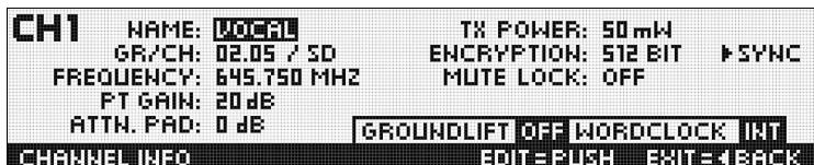
Das Kanalfenster bietet einen raschen Überblick über die Abstimmparameter (Gruppe/Kanal, Frequenz, Name, Land, Audioeingangsspegel des Taschensenders, Abschwächung (PAD), Sendeleistung, Verschlüsselung und MUTE LOCK). Sie können alle Parameter einstellen und an den Sender übertragen. Die Felder GROUNDLIFT und WORDCLOCK zeigen den entsprechenden aktuellen Betriebszustand an.
